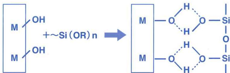
下地の反応基と結合し、より強固に密着します。
